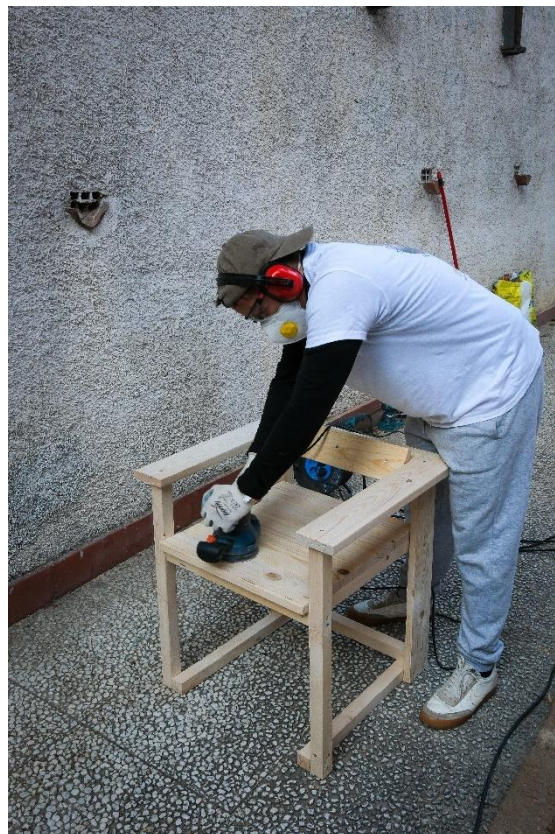
Fig.5 – Fase di levigatura di una sedia.
