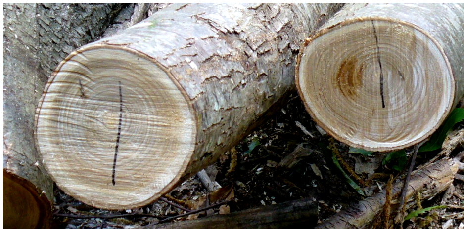
Figura 5 - Toppi destinati a paleria per agricoltura. È facilmente distinguibile la porzione di fusto che è duramificata da quella di alburno.
