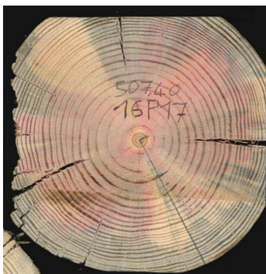
Figura 10: Esempio di sezione trasversale di una trave di pino nero tipo Uso Fiume, oggetto di sperimentazione dell'ambito del progetto IFEELWOOD. La colorazione anomala non ha rilevanza ai fini dell'impiego strutturale
