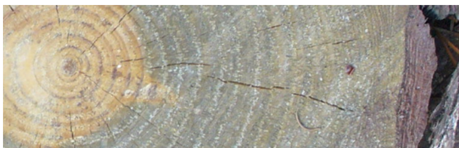
Figura 9: Porzione di un toppo di pino nero. È visibile il durame intatto a sinistra, attorno al midollo, e l'alburno completamente azzurrato a destra sino alla corteccia. L'alburno occupa gli ultimi trenta anelli di accrescimento annuali.
